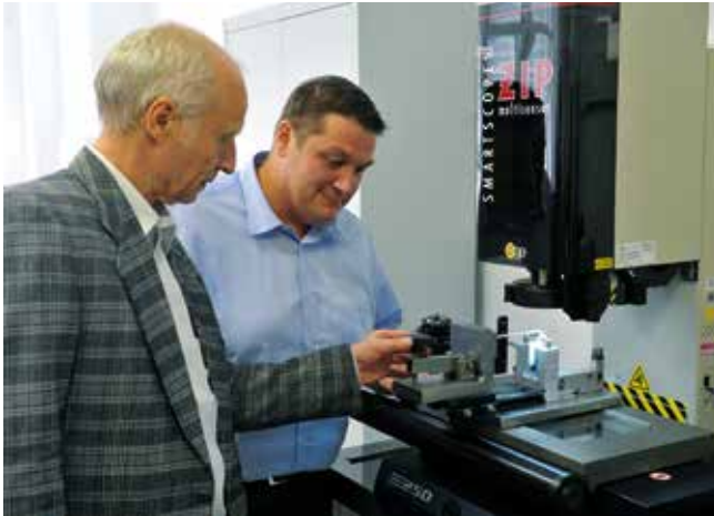
Bild 2. Dieter Schwenk (links) und Marcel Heß überprüfen am Videomesssystem den Messaufbau zur Bestimmung des Elastizitätsmoduls.
