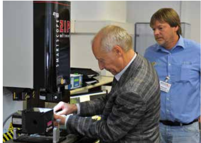
Bild 3. Dieter Schwenk (links) und Stefan Weber konfigurieren das Weißlichtinterferometer mit erweitertem Wechselobjektivsatz.
