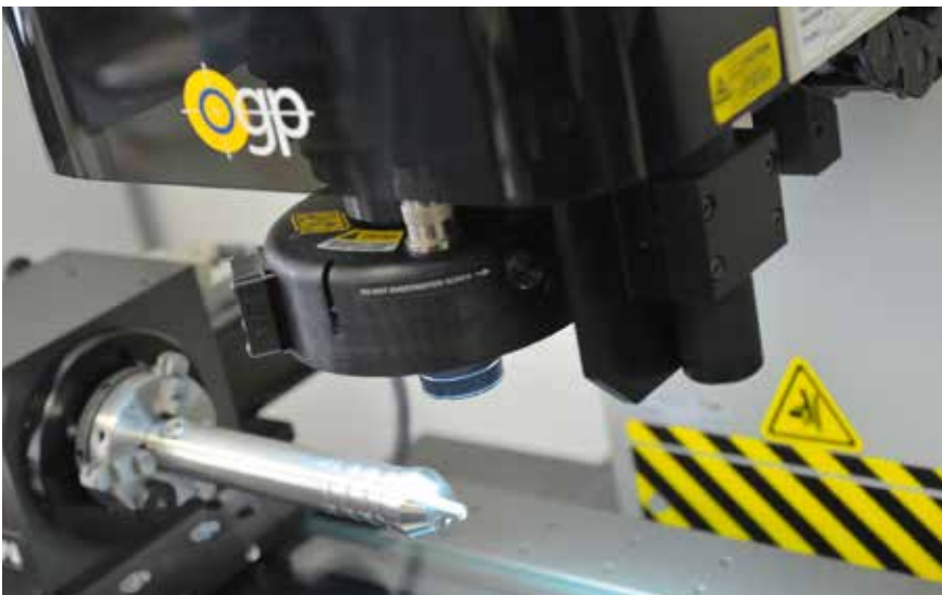
Bild 1. Videomesssystem mit Video, 3D-Taster, Laser und Weißlichtinterferometer für komplette 3D-Messungen an komplexen Messobjekten (© Harald Richter, Image-Text)
