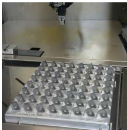
Bei LMT Kieninger werden auf automatisierten Anlagen Hartmetall-Wendeplatten mit höchster Präzision gefertigt.
