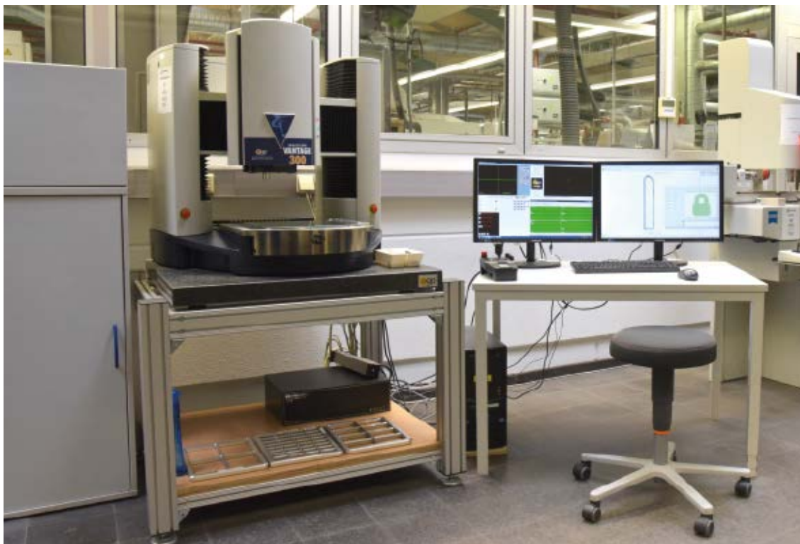
Mit dem kompakten Multisensor-Mess-System OGP Smartscope Vantage 300 wurde in der Qualitätssicherung bei LMT Kieninger ein moderner und flexibler Messplatz eingerichtet. Hier werden u.a. Hartmetall-Wendeplatten während der Produktion und in der Endkontrolle gemessen.
