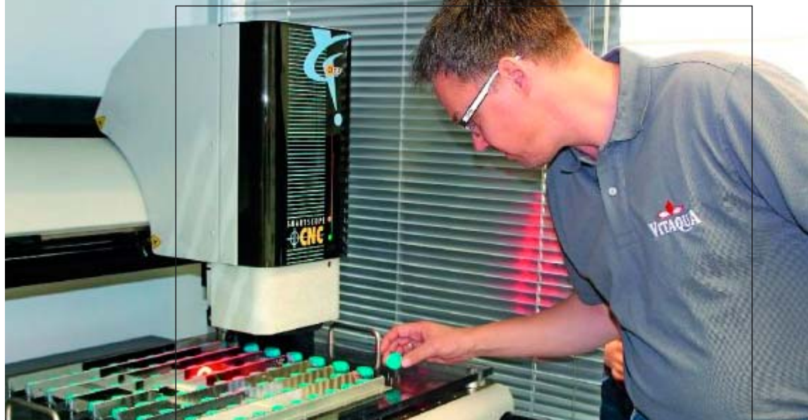
Harald Hefer, Leiter Verschlussproduktion bei Vitaqua, vor dem Smartscope CNC 500 von OGP: 80 Verschlüsse vermisst es optisch in einer Zeit von rund 90 min Bilder: Quality Engineering
